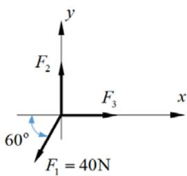
平面平衡汇交力系，试求 $F_2$ 和 $F_3$
